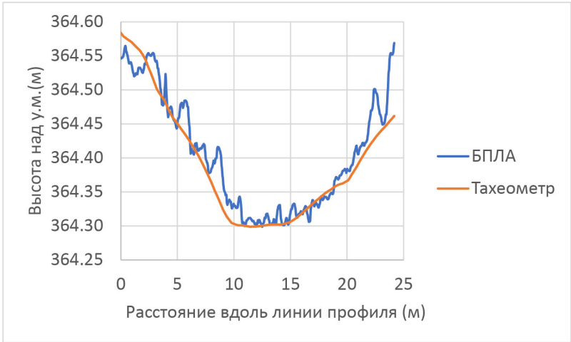
Рис. Сравнение профилей рельефа для жилищной впадины No. 1, пос. Лебяжье-4, сгенерированных с помощью тахеометра и БПЛА.
