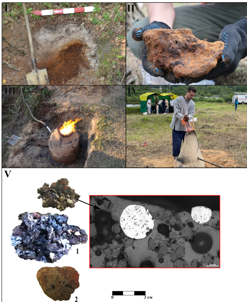
Рис. Экспериментальная плавка. I – месторождение болотной руды на берегу оз. Чашкинское; II – конкреция болотной руды; III – процесс плавки – интенсивное дутье; IV – процесс плавки – загрузка шихты (эксп. 2); V – результат плавки (1 – части горновой крицы ошлакованной, недовосстановленной – ан. 14070; 2 – руда ошлакованная невосстановленная).
